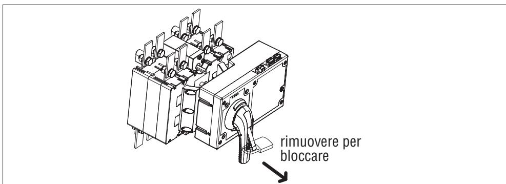
Il segnale di uscita tra i morsetti 8 e 9 viene attivato solo quando il comando motorizzato è bloccato tramite l'utilizzo della leva lucchettabile.
