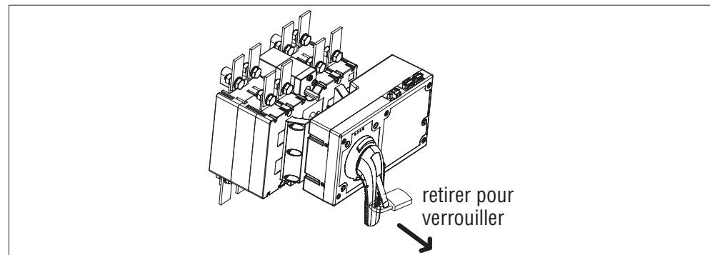
Le signal de sortie entre les bornes 8 et 9 n'est activé que quand la commande motorisée est bloquée à l'aide du levier cadenassable.
