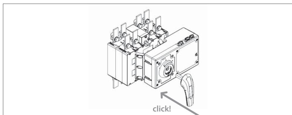
Nachdem der Griff blockiert ist, schaltet die Einheit in den manuellen Betrieb und die Bewegungen können nur noch über den zusätzlichen Griff für die manuelle Ansteuerung erfolgen
