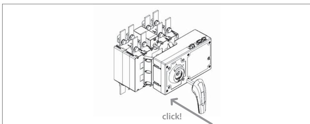
Une fois que la poignée est verrouillée, l'unité passe en mode de fonctionnement manuel et les mouvements ne peuvent être effectués qu'avec la poignée auxiliaire d'actionnement manuel.
