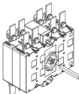
3 - Positionner l'interface et la visser sur le commutateur en utilisant des vis M5x15 DIN7985 (x 6) et des rondelles AET 5,3 (x 6) déjà incluses dans le kit.
