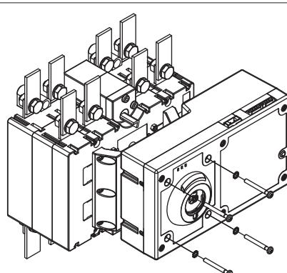
5 - Colocar los conectores (CN1, CN2, CN3) y realizar las conexiones según el esquema eléctrico (ver anexo 3, pág. 52).
