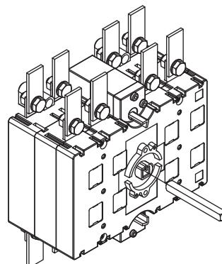
3 - Posizionare l'interfaccia ed avvitarla sul commutatore usando viti M5x15 DIN7985 (q.tà 6) e rondelle AET 5,3 (q.tà 6) già incluse nel kit.
