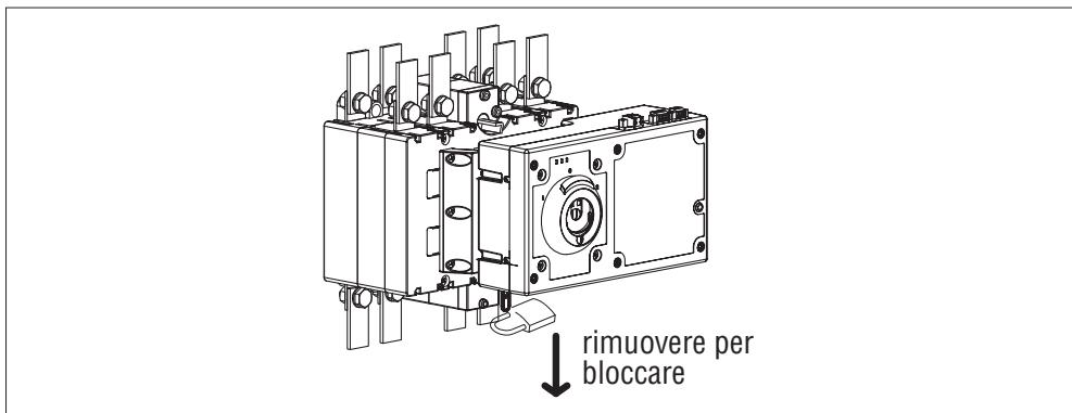
**BLOCCAGGIO DELL'UNITÀ TRAMITE LA MANIGLIA AUSILIARIA DI AZIONAMENTO MANUALE**
