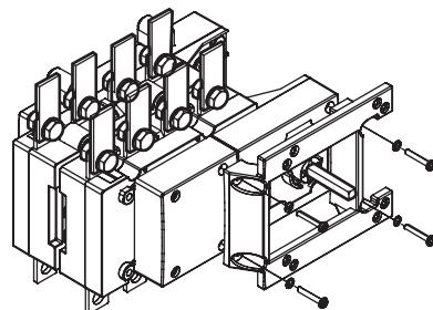
4 - Visser l'unité motorisée [avec le commutateur et l'unité moteur sur la position 0 (OFF)]. Les vis M5 x 75 DIN 7985 (x 4), les rondelles AET 5,3 (x 4) et les écrous M5 DIN 933 (x 4) sont compris dans le kit.
