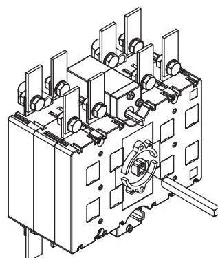
3 - Die Schnittstelle korrekt ausrichten und mit den zum Kit gehörenden Schrauben M5x15 DIN7985 (6 Stk.) und Unterlegscheiben AET 5,3 (6 Stk.) am Schaltgerät befestigen.
