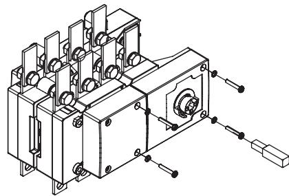
3 - Die Schnittstelle korrekt ausrichten und mit den zum Kit gehörenden Schrauben M3.5x30 DIN7985 (4 Stk.) und Unterlegscheiben AET 4,3 (4 Stk.) am Schaltgerät befestigen.
