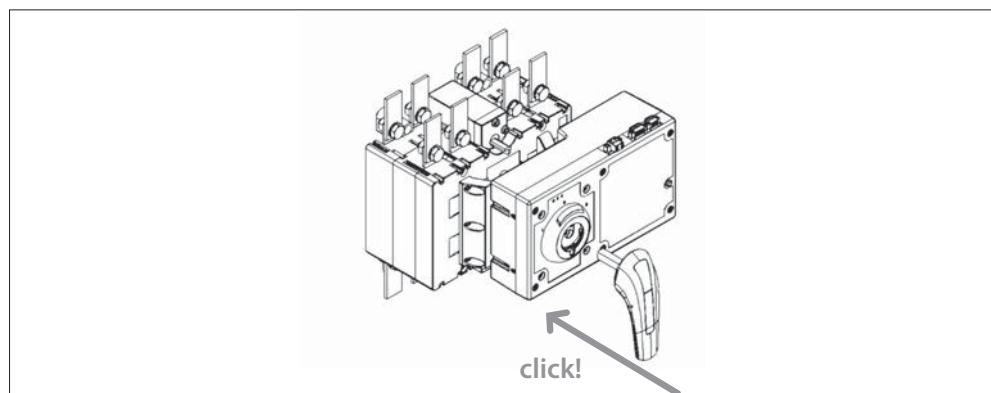
Una volta bloccata la maniglia l'unità passa al funzionamento manuale ed i movimenti possono essere effettuati unicamente con la maniglia ausiliaria di azionamento manuale.
