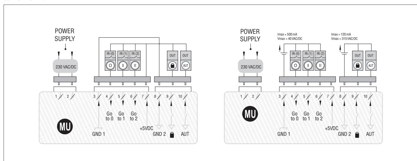
Esquema eléctrico propuesto para alimentación ininterrumpida exterior K1, K2 = 230VAC = Bobina 230VAC
