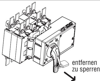
Das Ausgangssignal zwischen den Klemmen 8 und 9 wird nur dann aktiviert, wenn der Motorantrieb durch Verwendung des Hebels mit Vorhängeschloss gesperrt ist.
