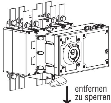
**BLOCKIERUNG DER EINHEIT ÜBER DEN ZUSÄTZLICHEN GRIFF FÜR DIE MANUELLE BETÄIGUNG**
