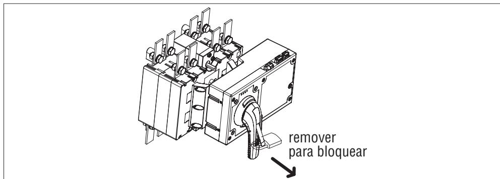
La señal de salida entre los bornes 8 y 9 sólo se activa cuando el mando motorizado está bloqueado mediante la palanca enclavable.
