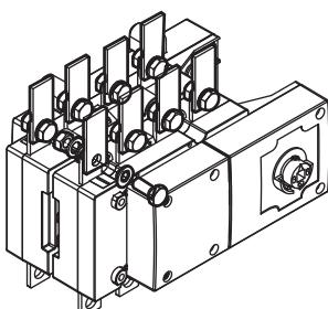
2 - Insertar eje en el conmutador y apretarlo utilizando una llave allen 2,5 DIN 90011. Sin quitar la tapa frontal del mecanismo de salto, extraer los cuatro tornillos indicados.
