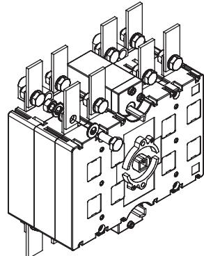
2 - Insertar eje en el commutador y apretarlo utilizando una llave allen 2,5 DIN 90011.
