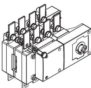
2 - Inserire l'albero di collegamento e fissarlo con una chiave a brugola da 2,5 DIN 90011. Senza togliere il coperchio anteriore, togliere le quattro viti indicate.
