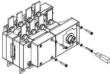
3 - Positionner l'interface et la visser sur le commutateur en utilisant des vis M3.5x30 DIN7985 (x 4) et des rondelles AET 4,3 (x 4) déjà incluses dans le kit.
