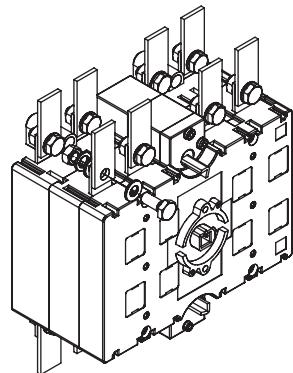
2 - Die Verbindungswelle einbauen und mit einem Inbusschlüssel 2,5 DIN 90011 befestigen.
