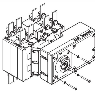
5 - Montare i connettori (CN1, CN2, CN3) ed effettuare i collegamenti sulla base dello schema elettrico (vedere allegato 3, pagina 19).
