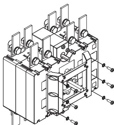
4 - Montar y atornillar la unidad de motorización (con el commutador y **UM** en posición 0). Tornillos M5 x 75 DIN 7985 (x 4), arandelas A.E.T. 5,3 (x 4), tuercas M5 DIN 933 (x4) incluidos.
