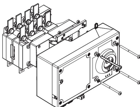
5 - Monter les connecteurs (CN1, CN2, CN3) et effectuer les branchements en se basant sur le schéma électrique (voir annexe 3, page 41).
