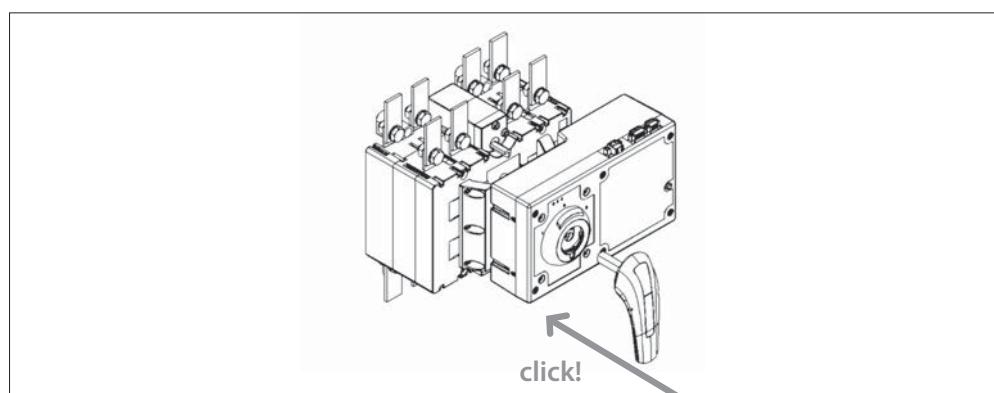
Una vez enclavado la unidad pasa a modo manual y las maniobras se realizan con el mando auxiliar de accionamiento manual.
