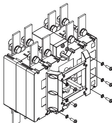
4 - Die Einheit mit Antrieb [mit Schaltgerät und Motor in Position 0 (OFF)] aufschrauben. Die Schrauben M5 x 75 DIN 7985 (4 Stk.), die Zwischenlegscheiben AET 5,3 (4 Stk.) und die Muttern M5 DIN 933 (4 Stk.) sind im Kit enthalten.
