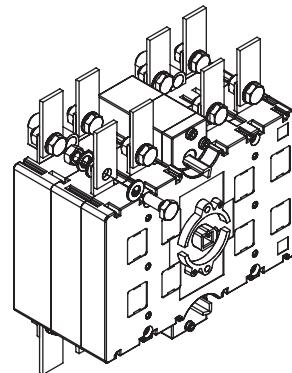
2 - Inserire l'albero di collegamento e fissarlo con una chiave a brugola da 2,5 DIN 90011.
