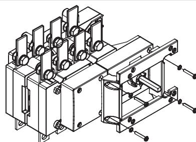
4 - Die Einheit mit Antrieb [mit Schaltgerät und Motor in Position 0 (OFF)] aufschrauben. Die Schrauben M5 x 75 DIN 7985 (4 Stk.), die Zwischenlegscheiben AET 5,3 (4 Stk.) und die Muttern M5 DIN 933 (4 Stk.) sind im Kit enthalten.
