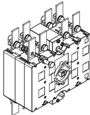
2 - Introduire l'arbre d'accouplement et le fixer à l'aide d'une clé Allen de 2,5 DIN 90011.
