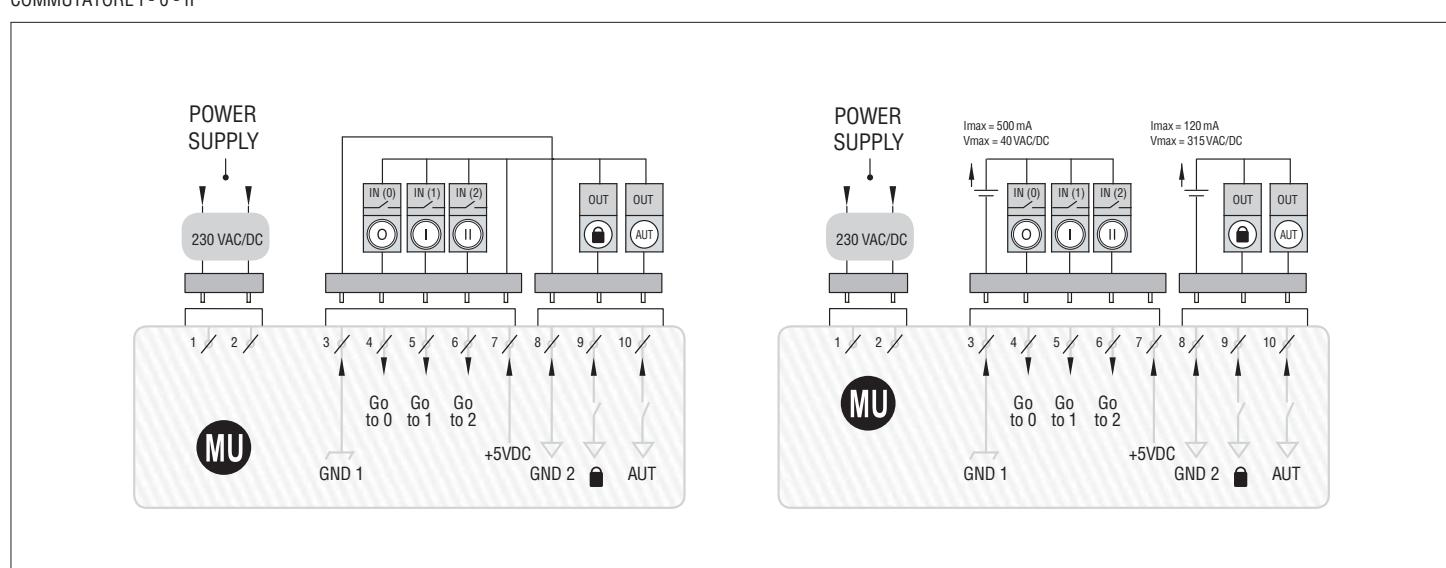
Cablaggio proposto per alimentazione continua esterna K1, K2 = 230VAC = Bobina 230VAC
