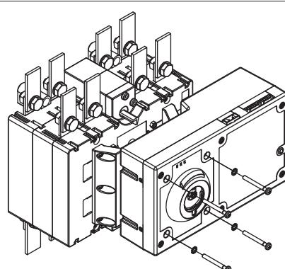
5 - Monter les connecteurs (CN1, CN2, CN3) et effectuer les branchements en se basant sur le schéma électrique (voir annexe 3, page 41).
