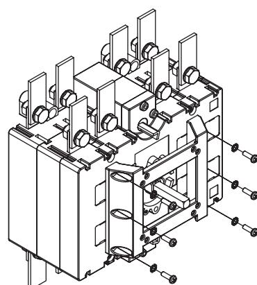
4 - Visser l'unité motorisée [avec le commutateur et l'unité moteur sur la position 0 (OFF)]. Les vis M5 x 75 DIN 7985 (x 4), les rondelles AET 5,3 (x 4) et les écrous M5 DIN 933 (x 4) sont compris dans le kit.
