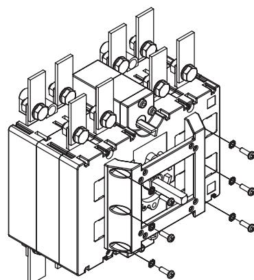
4 - Avvitare l'unità motorizzata [con commutatore e unità motore in posizione 0 (OFF)]. Le viti M5 x 75 DIN 7985 (q.tà 4), le rondelle AET 5,3 (q.tà 4) e i dadi M5 DIN 933 (q.tà 4) sono compresi nel kit.
